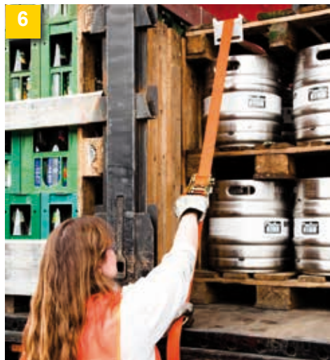
6 Завързване: Въпреки, че прицепът е сертифициран (по DIN EN 12642, код XL за напитки), палетираният товар трябва да бъде завързан към пода на камиона.
