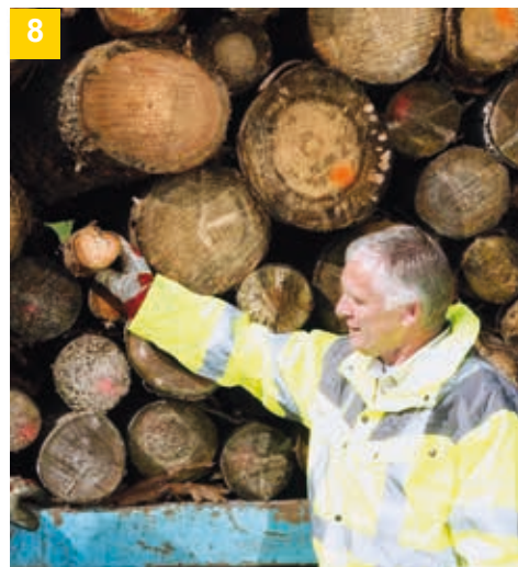
8 При дървени трупи под 4 метра, не допускайте да се образуват празнини в купа трупи. Намиращите се вътре не добре притиснати трупи могат да се изплъзнат от купа.
