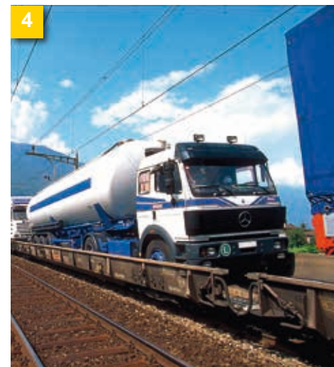
„Шосе на релси“: Превозни средства, предназначени изцяло за шосеен транспорт, се покачват на собствен ход върху специални ниски железопътни вагони.
