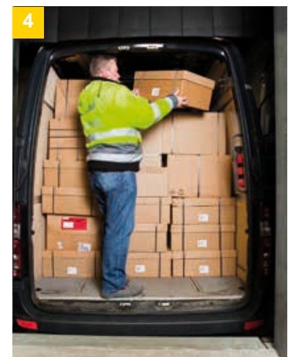
4. Планиране: При товарене внимавайте за разпределяне на товара, плътното му подреждане, теглото му (тежкото отдолу, лекото върху него) и за планиране на маршрута.
