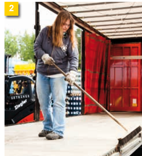
2 Условие: Трябва да разполагате с подходящ камион (по DIN EN 12642, код XL за напитки), а товарната повърхност да е старателно изметена.
