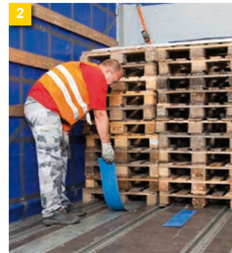
2 Правилно разстояние: За спазване на плана за разпределение на товара са използвани празни палети за запазване на разстоянието до челната стена.
