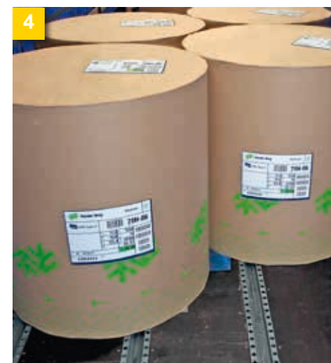
4 Поставете хартиените рула симетрично спрямо надлъжната ос на камиона. При това трябва да внимавате ролата да се опират едно в друго.
