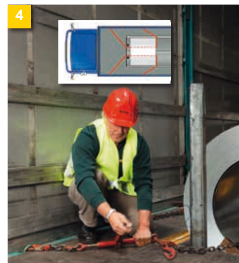
Поставете средствата за завързване (виж графиката) и обезопасете с тях намотката срещу изплъзване назад и претъркулване встрани.
