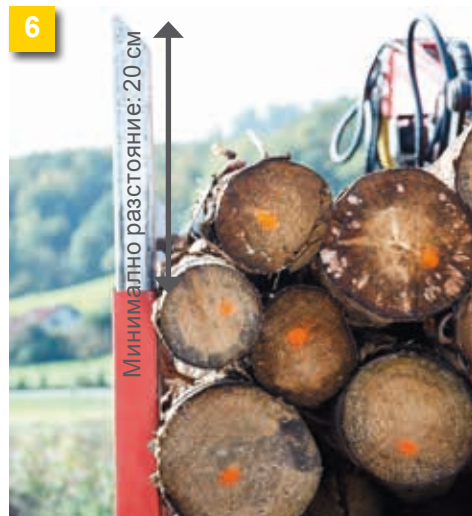
6 Уплътняване: Шприглите трябва да стърчат поне 20 см над средната точка на най-горното дърво, което се опира до тях.
