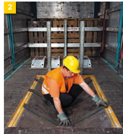
Първа стъпка: Поставете подложките срещу плъзгане между намотката и подложното корито, на ивици, широки около 15 см.
