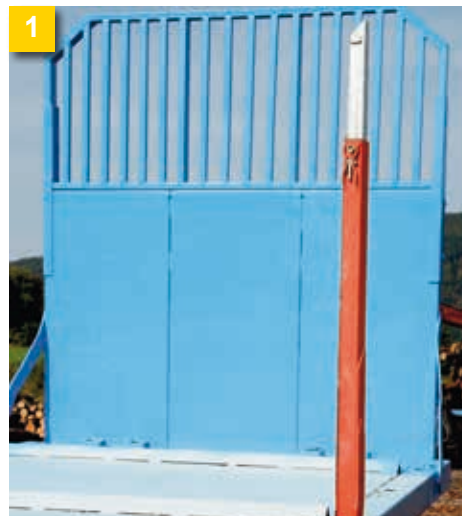
1 Подходящ камион (пример) с изметена товарна повърхност, клинови лайсни, отвесни шпригли и достатъчно стабилна челна стена.
