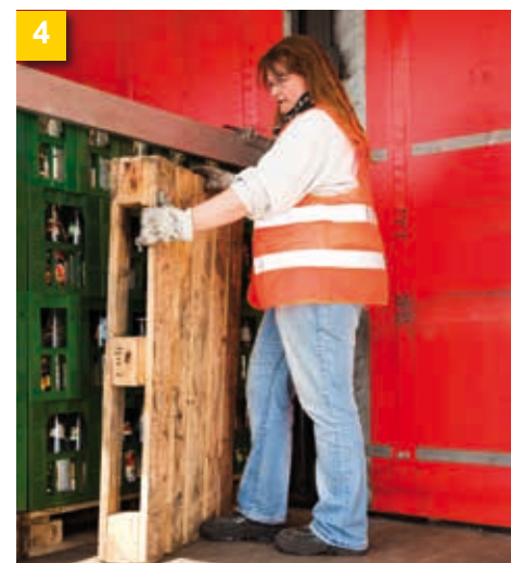
4 Обезопасяване: Водачката поставя отвесно празни палети до касите за напитки, за да ги предпази от буретата.
